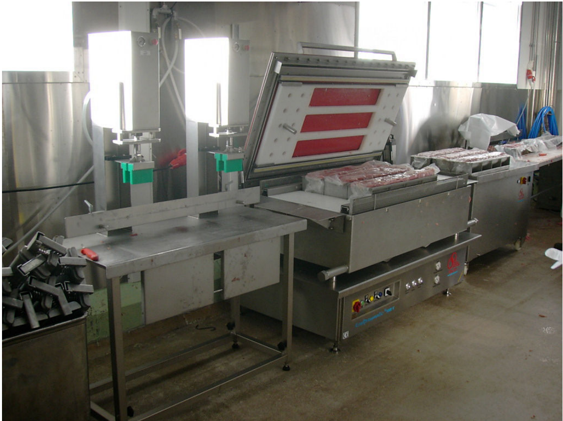
Kraftdeckelpresse DP 100 SLD als Linie aufgestellt mit einer Kraftpressmatic ® Typ 1000 VH mit externer Pumpe, zur Kochschinkenproduktion.
