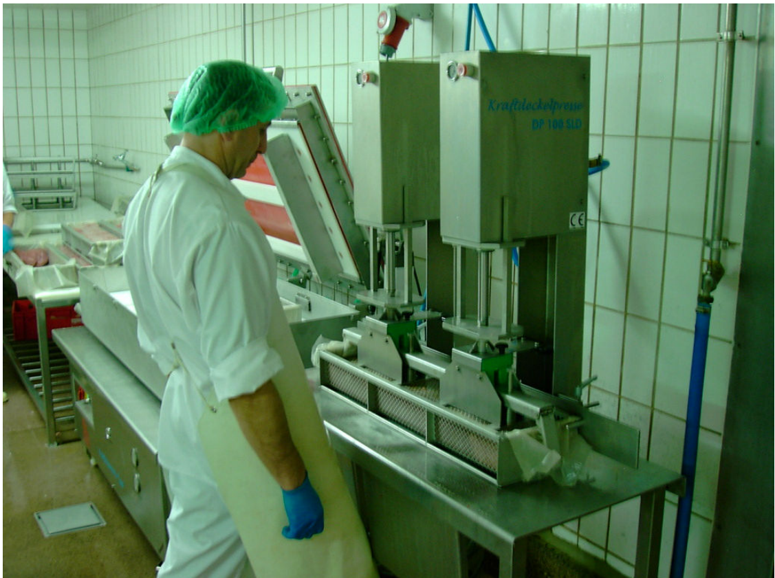
Kraftdeckelpresse DP 100 SLD als Linie aufgestellt mit einer Kraftpressmatic ® Typ 1000 N zur Rohschinkenproduktion.
