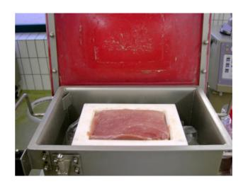
*Kraftpressmatic*<sup>®</sup> Automatische Kochschinkenpresse Typ 100, zum Vakuumieren und Pressen von Rohkochschinken in der Form. Dieses Verfahren ist patentrechtlich geschützt!
