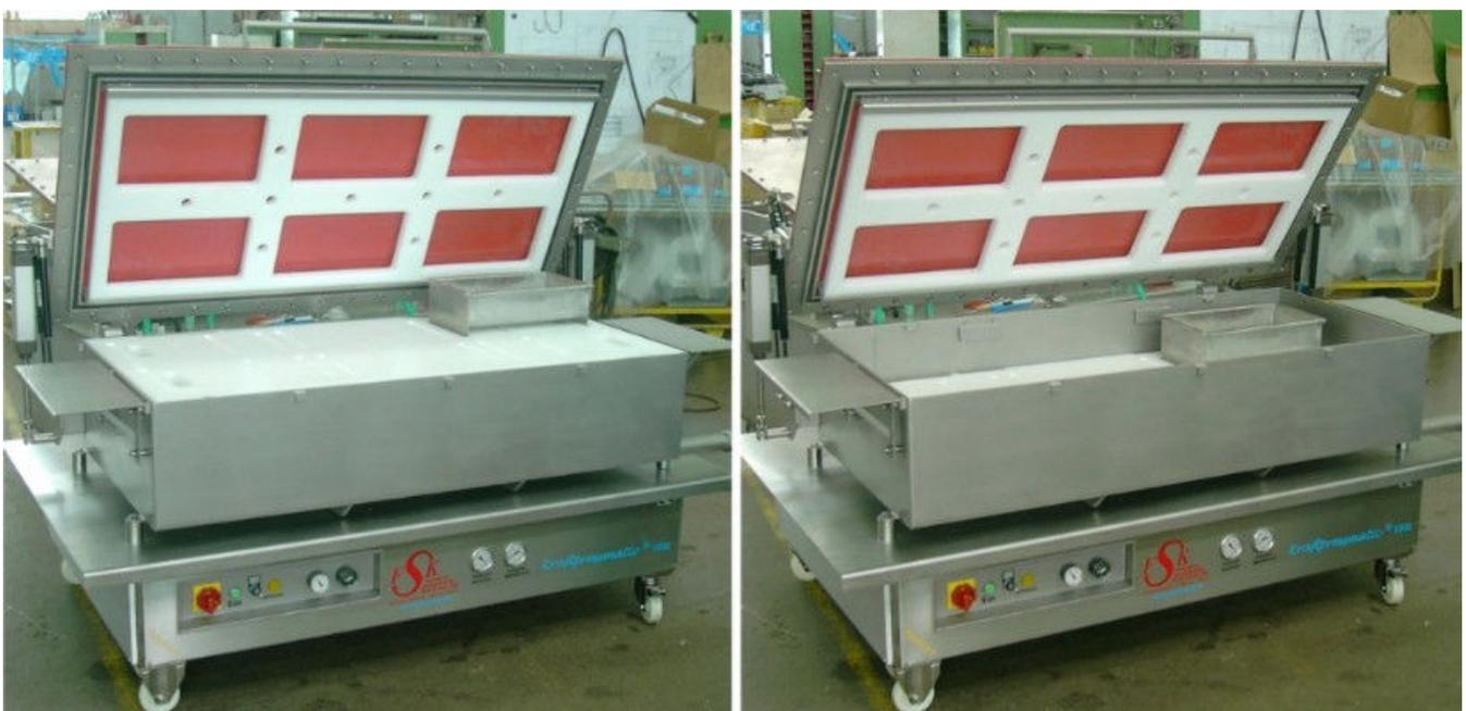
Die Hubvorrichtung arbeitet getaktet mit dem Deckel. Beim Schließen des Deckels fährt die Hubvorrichtung mit der gefüllten Form nach unten in die Kammer. Nach dem Pressen öffnet der Kammerdeckel automatisch und die Hubvorrichtung hebt die gepressten Formen wieder nach oben über den Kammerrand, so daß sie problemlos weiter zur Deckelpresse geschoben werden können. Somit sind auch große Slicerformen einfach zu Händeln.
