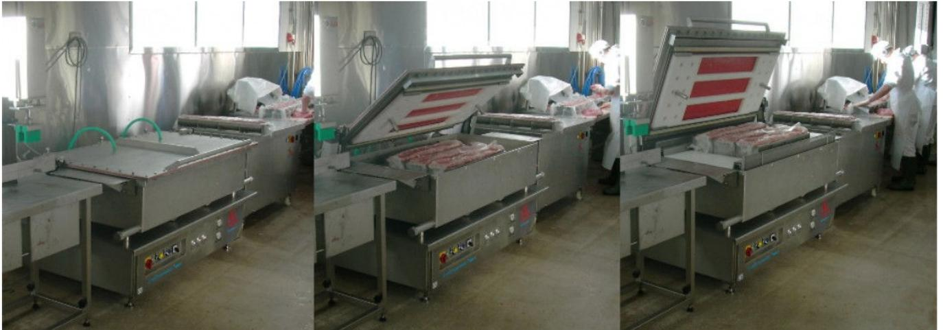
Der Arbeitsablauf läuft nach dem Deckelschließen automatisch bis zum Deckelöffnen ab.
