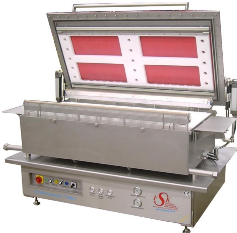
*Kraftpressmatic®* Typ 1000 VH Automatische Kochschinkenpresse, zum Vakuumieren, Pressen und Versiegeln von Rohkochschinken im Kochbeutel, in der Form. Dieses Verfahren ist patentrechtlich geschützt!
