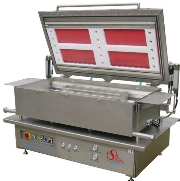
Die Hubvorrichtung arbeitet getaktet mit dem Deckel. Beim Schließen des Deckels fährt die Hubvorrichtung mit den gefüllten Formen nach unten in die Kammer. Nach dem Pressen öffnet der Kammerdeckel und die Hubvorrichtung hebt die gepressten Formen wieder nach oben über den Kammerrand, so daß sie problemlos weiter zur Deckelpresse geschoben werden können. Somit sind auch große Slicerformen einfach zu Händeln.
