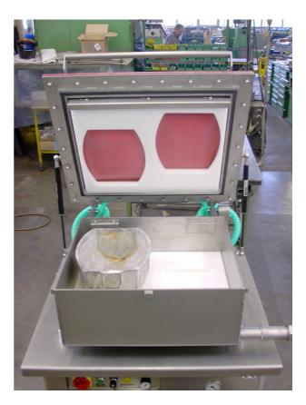
Beispiel für einen Formeneinsatz mit oberen Überfüllrahmen und unteren Zentrierrahmen, sowie der notwendigen Einlegeplatten für den Höhenausgleich der verschiedenen Formen. Die Rahmen für die verschiedenen Formentypen sind einfach und Werkzeuglos zu wechseln.
