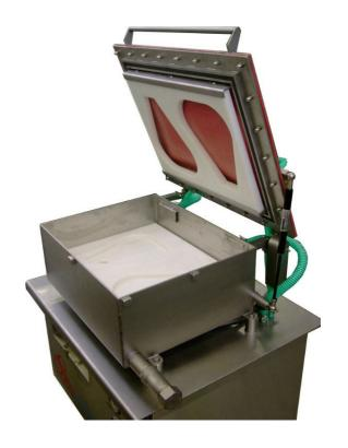
Bestehend aus Unter- oder Überfüllrahmen und unteren Zentrierrahmen, die exakt passend zu Ihren vorhandenen jeweiligen Kundenformen gefräst werden und damit ein optimales Pressen der Form ermöglichen.
