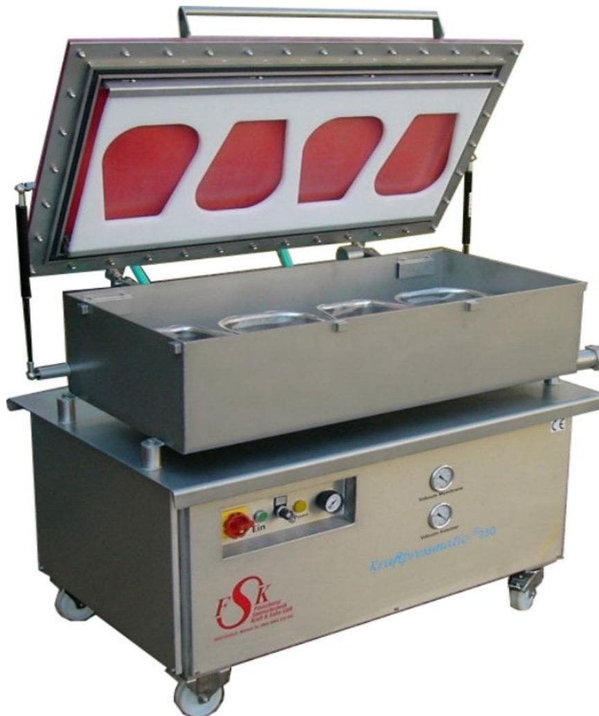
*Kraftpressmatic®* Automatische Koch- und Rohschinkenpresse Typ 250, zum Vakuumieren und Pressen von Schinkenfleisch in der Form.
