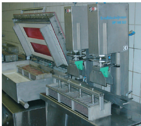
Abb. 2: Die Formen mit den unter Vakuum zusammengepressten Rohschinkenteilstücken werden mittels Deckelpresse (rechts) mit einem Deckel verschlossen.
