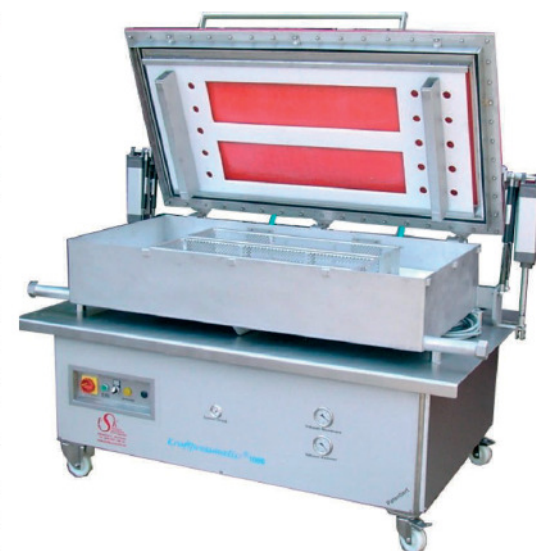
Abb. 1: Die Kraftübertragung auf die in der Vakuumkammer befindlichen Formen erfolgt über eine Membran (rote Flächen im Deckel).
